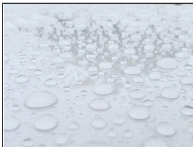
Гидрофобная поверхность (TOP-coat) LEGEND®PPF Raven
